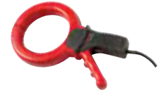
SC-3500, cęgi prądowe do przyrządu AT-3500
